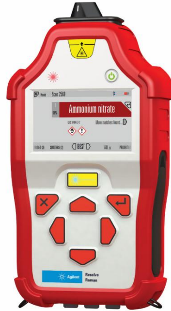
그림 1. Agilent Resolve 핸드헬드 라만 분석기는 마약, 폭발물, 화학전제 및 일반 화학 물질과 같은 다양한 숨겨진 물질을 감지할 수 있습니다.
